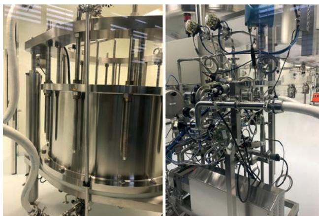
Рис. 3. Фракционирование и фильтрация
