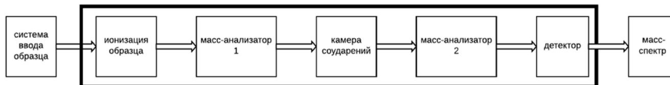
Рис. 1. Типичная блок-схема тандемного масс-спектрометра
